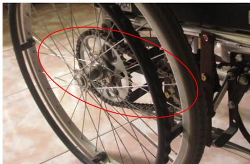
图 2. 连接雨刷电机和后轮的链条。
