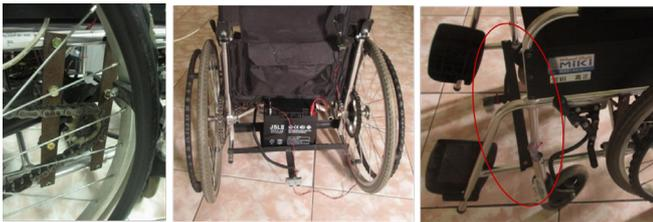
图 6. 用于雨刷电机，电池和超声波传感器的平行杆附件。
