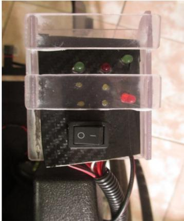
图 5. LED 指示灯安装在右侧扶手上。
