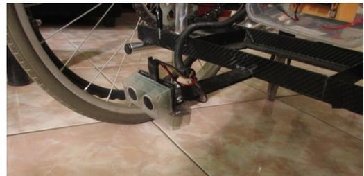
图 4: 安装在后部的传感器。
