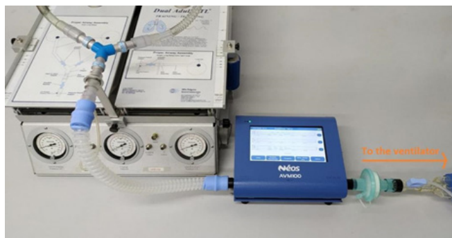
图2. 使用成人测试肺模拟器 (Dual Adult TTL, Michigan, USA) 进行的实验设置。橙色箭头指示连接呼吸机的方向。
