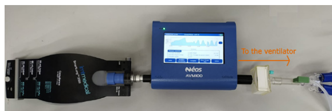
图1. 使用成人测试肺和呼吸机测试仪进行的实验设置。橙色箭头指示连接呼吸机的方向。
