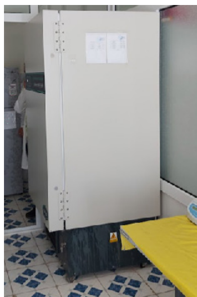
图 1. 这台冰箱体积过大，并不适合在中亚国家的小型艾滋病预防实验室中使用。
